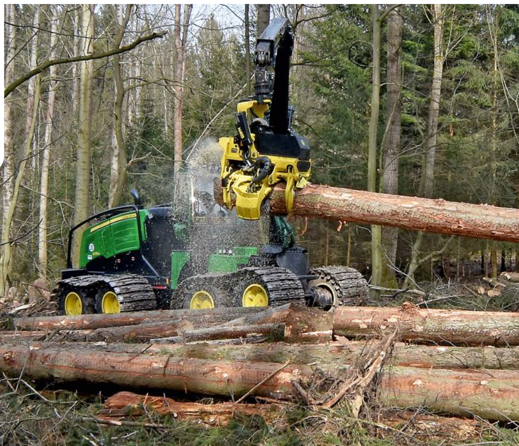
... während es mit vertikalem Sägekasten bis zu 75 Zentimeter starke Bäume packen und sägen kann. Grafiken: John Deere
